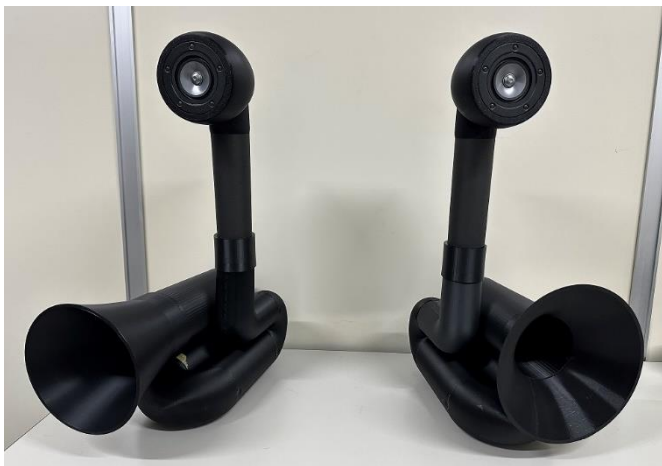
図1 スピーカーの外観 (敢えて左右でホーン開口部を変えています)
