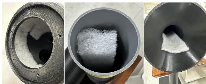
図 6 吸音材の使用例
