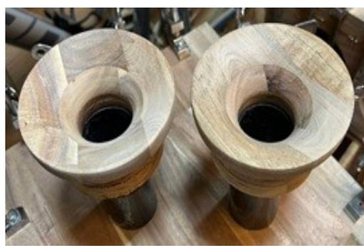
木工旋盤で削り出したショートホーンに40φの塩ビ管を付けています。
