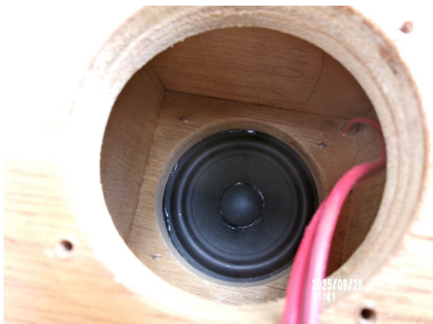
インナーユニットの様子
