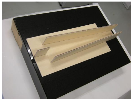
図3. 第1&第2音道の構成
